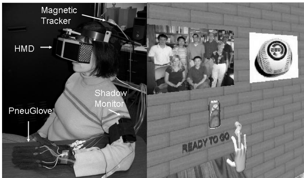
Figura 3.11 - Dispositivo PneuGlove e ambiente virtual (ADAMOVICH et al., 2004)
